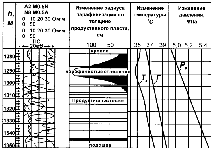
Рис. 5.8. Зависимость изменения радиуса парафинизации по толщине продуктивного пласта
