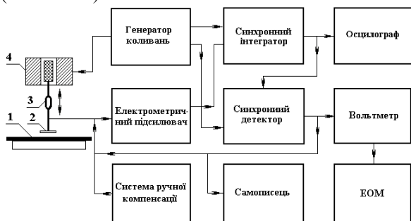
Рис. 2. Схема установки для вимірювання контактної різниці потенціалів поверхні кремнієвих пластин
