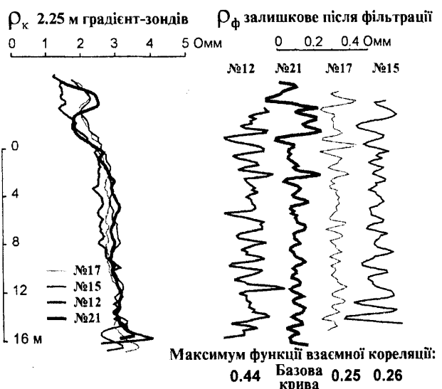
Рисунок 2 – Порівняння діаграм позірного опору 2.25 м градієнт-зонда до і після фільтрації. Рубанівське газове родовище, горизонт ВД-11
