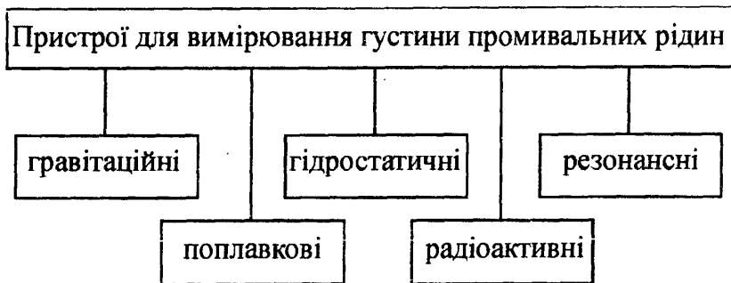
Рисунок 2 — Класифікація пристроїв для вимірювання густини промивальних рідин
