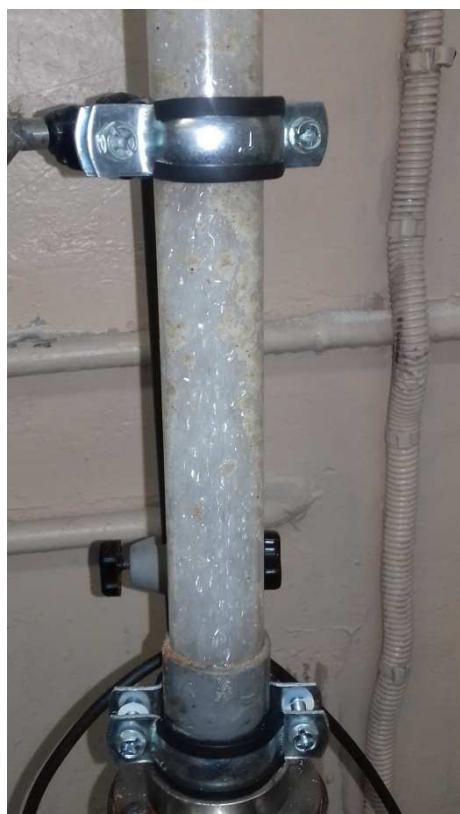
Рисунок 2 – Фотографія скляної колонки під час винесення частинок піску піною
