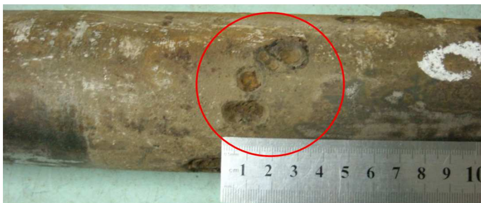
б) локальні корозійні каверни, максимальна глибина 3,2 мм;
