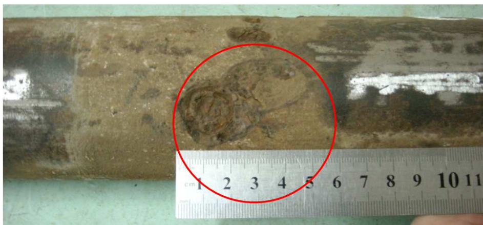
а) локальна корозійна каверна, максимальна глибина 3 мм;
