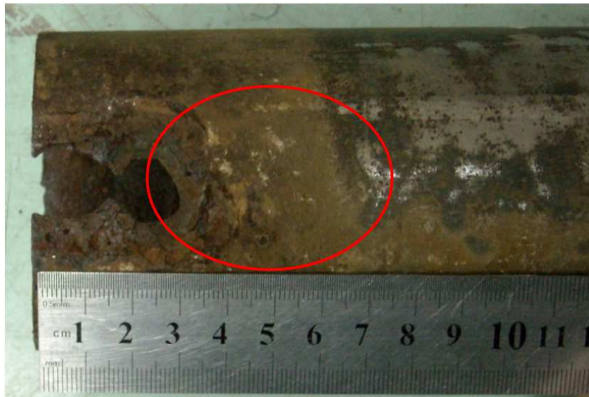
е) наскрізний дефект корозійного походження, протяжність 40 мм;
