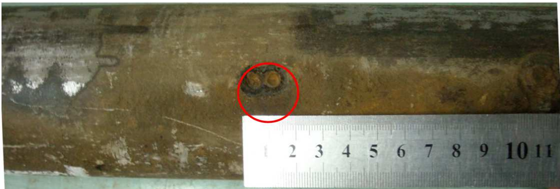
д) локальні корозійні каверни розмірами 8 мм, глибина 1,8 мм;
