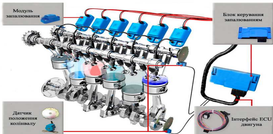
Рисунок 10 – Загальна будова системи запалення для конвертації дизельного двигуна
