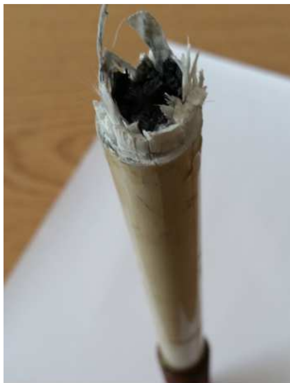
Рисунок 9 – Злам гібридної насосної штанги
