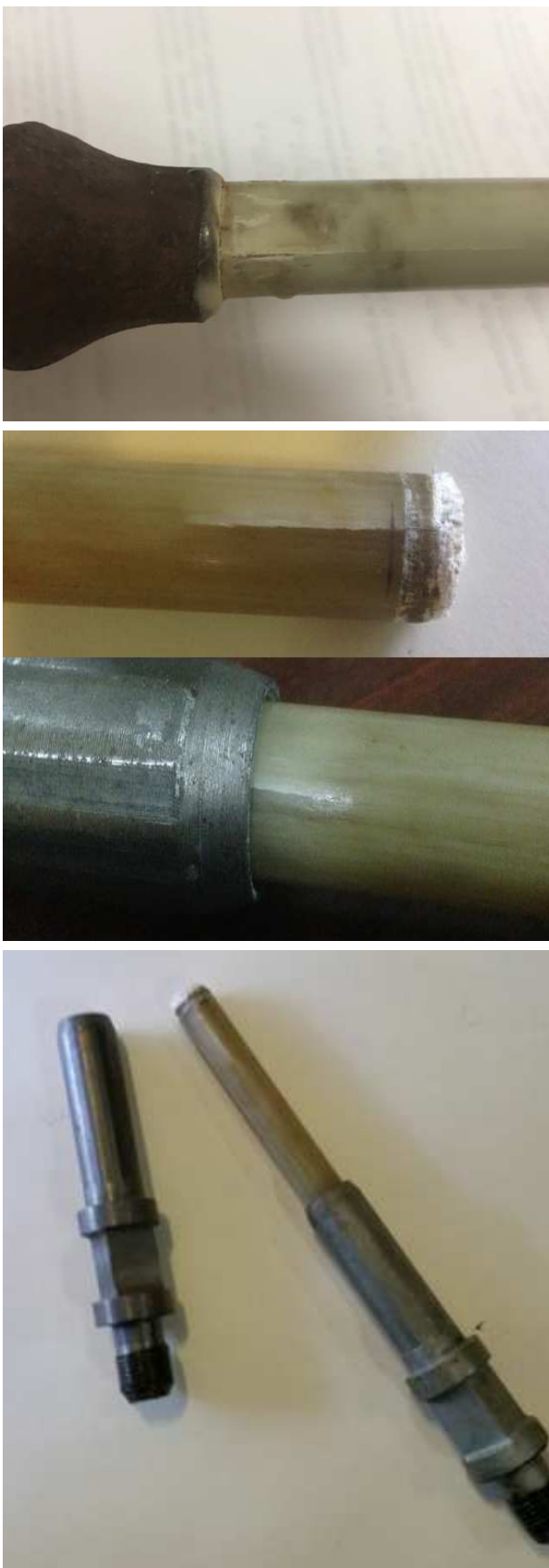
Рисунок 5 – Загальний вигляд зразка гібридної штанги (зліва) з повздожнім розшаруванням (з тріщиною довжиною до 32мм) та склопластикових штанг (справа) після розвитку тріщини і кінцевої поломки (внизу) після випробувань на втому при згині
