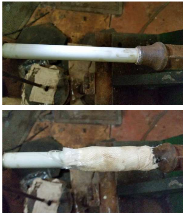
Рисунок 6 – Загальний вигляд зразка гібридної штанги з повздожнім розшаруванням (з тріщиною довжиною до 32 мм) та склопластиковим бандажем для випробувань на втому при згині
