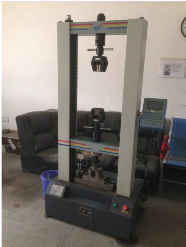
Рисунок 3 – Стенд Instron 8500 для випробування на втомну міцність гібридних насосних штанг при асиметричному циклічному розтязі
