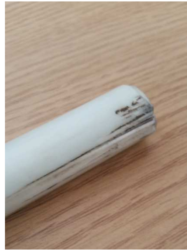
Рисунок 1 – Поперечний зріз гібридної насосної штанги з тріщиною, яка утворилася у вуглепластиковій серцевині (ліворуч) та розшарування склопластикової оболонки гібридної насосної штанги, яке утворилося після експлуатації в свердловині (праворуч) на промислах в Китаї
