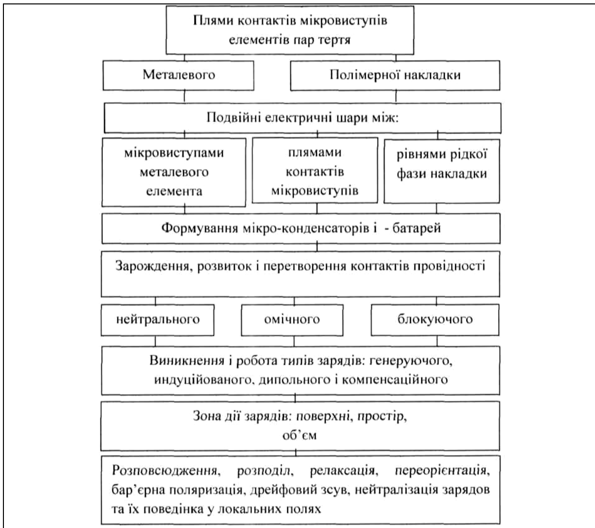
Енергетичні рівні плям контактів мікроставуків елементів пар тертя при електротермомеханічному терті фрикційної взаємодії
