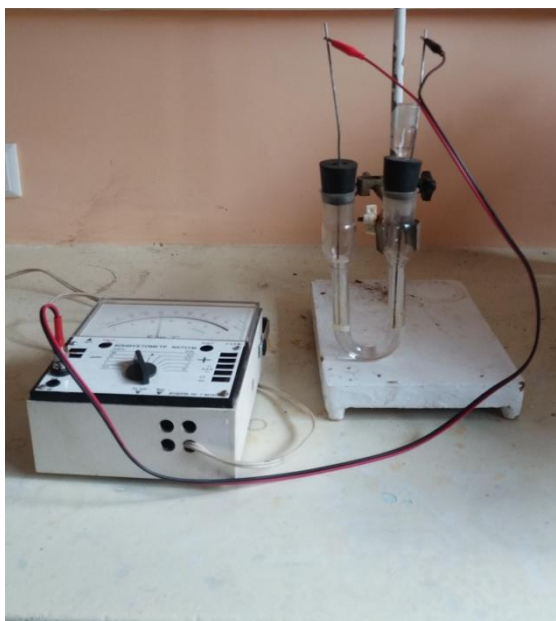
Рис. 2.5 - Світлина вимірювання опору за допомогою кондуктометра фірми «Елвро» марки N5721M.
