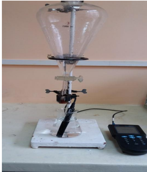
Рис. 2.9 - Світлина вимірювання електропровідності за допомогою кондуктометра sensION 5 фірми «Hach».
