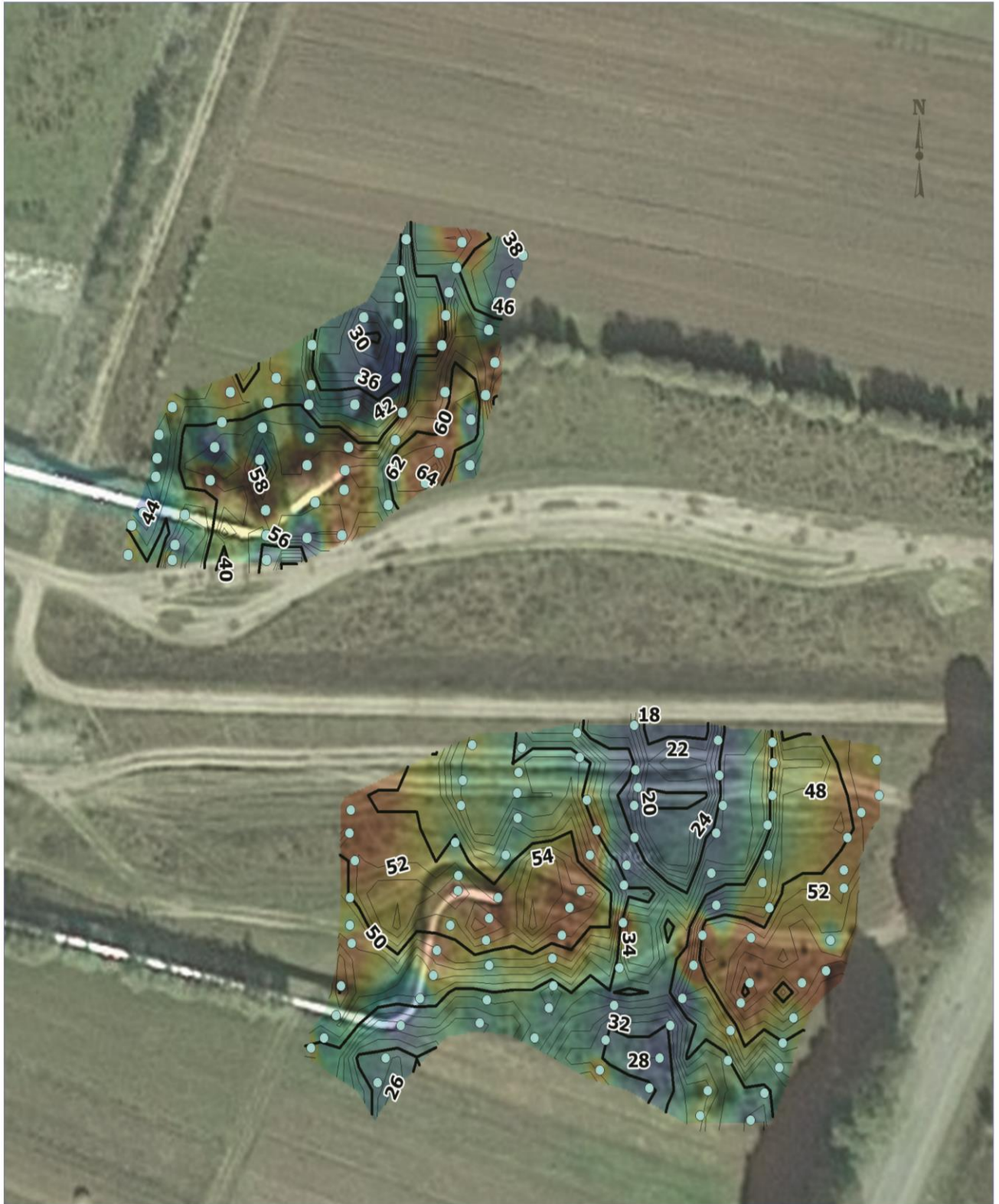
Рисунок 5.15 – Інтенсивність випромінювання електромагнітного поля Землі, масштаб 1:1000, повний вектор напруження T
