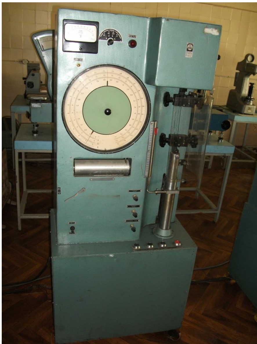
Рисунок 2.7 – Розривна машина Р-10 за допомогою якої проводились експериментальні випробовування.
