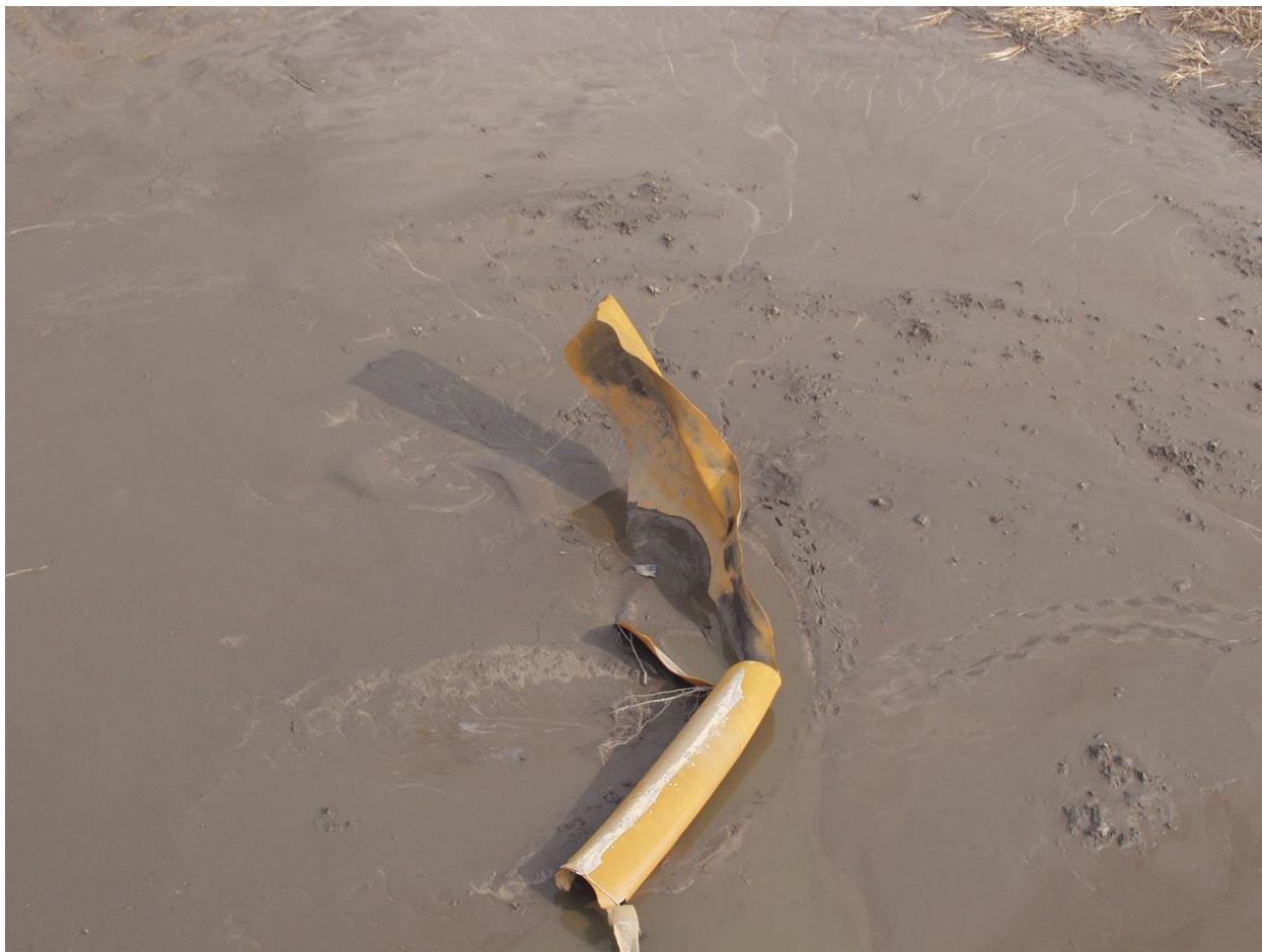
Рисунок 1.9 – Фрагмент аварії газопроводу “Уренгой – Помари – Ужгород”, що відбулася в квітні 2003 р. поблизу Ставищенської КС
