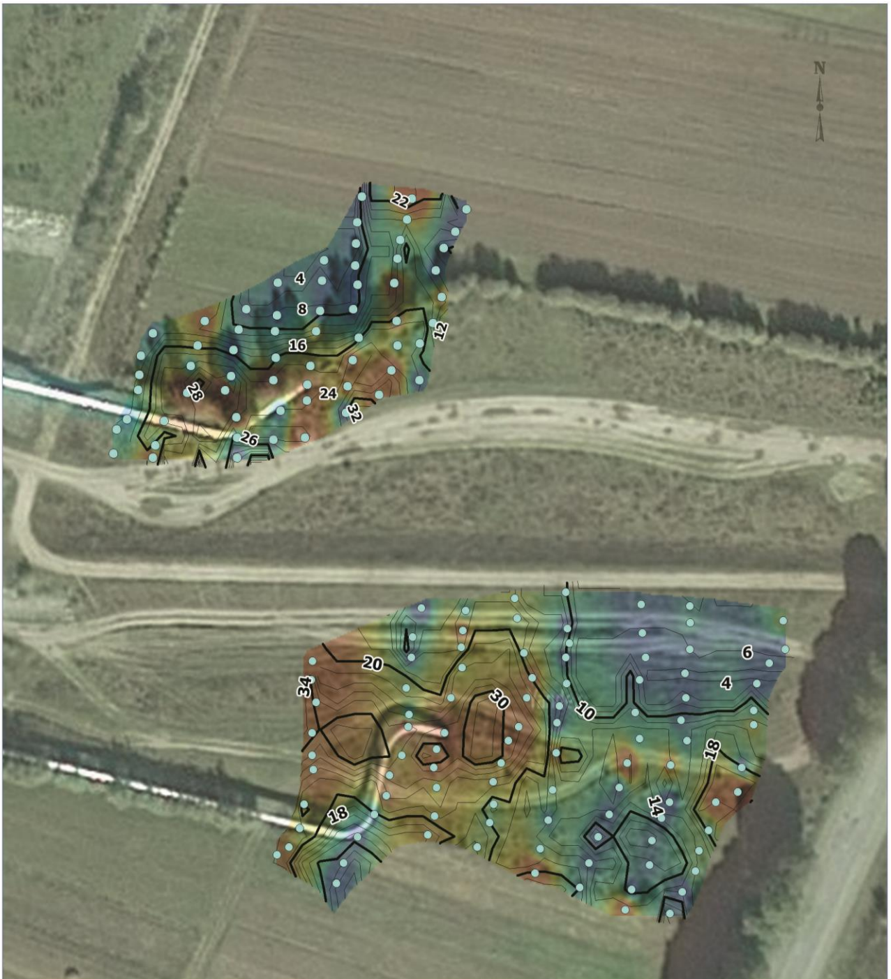
Рисунок 5.13 – Інтенсивність випромінювання електромагнітного поля Землі, масштаб 1:1000, напрям антени Y
