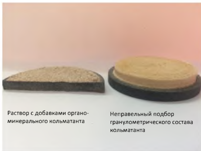
Рис. 6. Пример неправильного подбора гранулометрического состава коагулянта и отсутствие в составе раствора реагента AlevroN ® .
