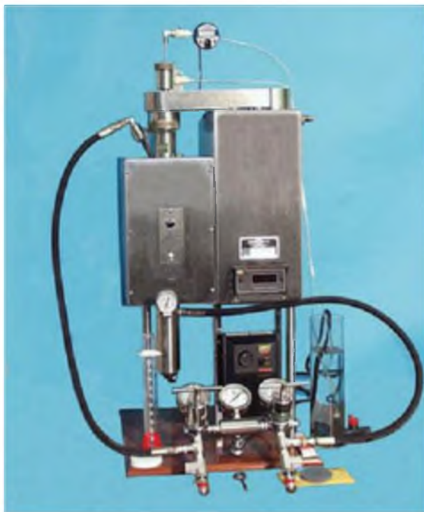
Рис. 2. Ячейка для исследуемой жидкости и механическая часть с валом и пропеллером.
