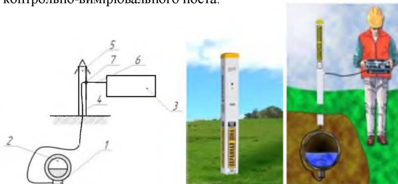
Рисунок 1 – Реалізація системи для вимірювання рівня нетехнологічної рідини у порожнині газопроводу на базі контрольно-вимірювального поста:
