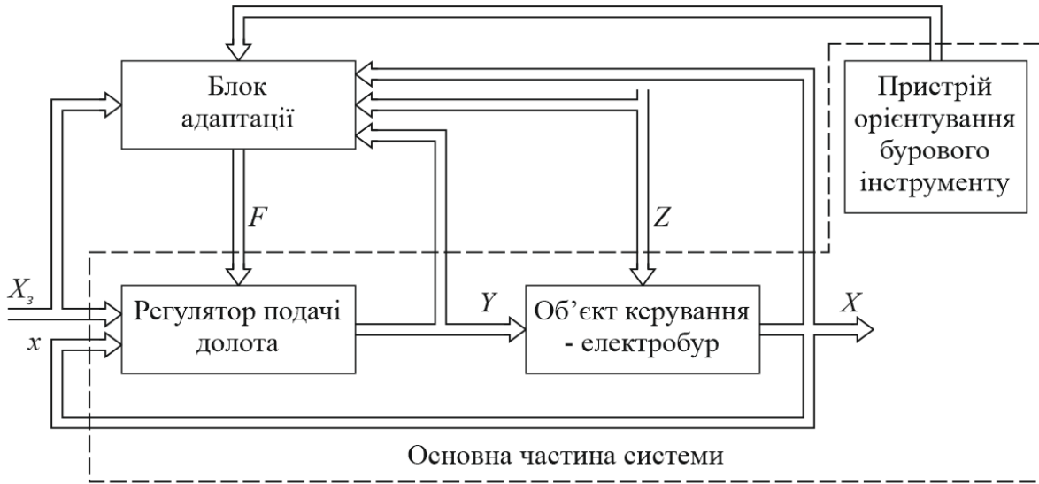
Рис. 2. Функціональна структура адаптивної системи керування бурінням свердловин електробурами: X – вектор стану ОК; Z – вектор збурень; X_3 – вектор вхідних впливів; Y – вектор параметрів керування з координатами y_1, y_2, \dots, y_m ; F – сигнал переналаштування регулятора подачі долота відповідно до прийнятого критерію якості роботи адаптивної системи
