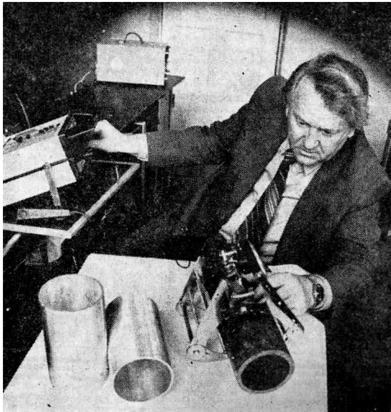
Зав. сектору відділу неруйнівного методу контролю СКТБ «Надра» П. Я. Криничний під час лабораторного дослідження труб при допомозі установки «Зонд»
