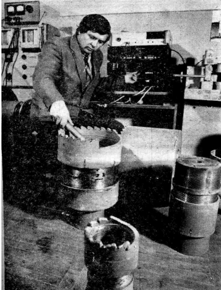
Інженер СКТБ «Надра» М. Телезин перевіряє магнітні характеристики вловлювачів
