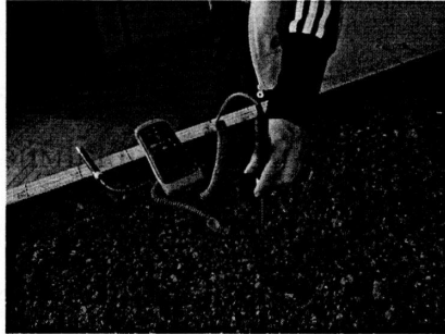
Рис.3.7. Процес вимірювання температури ґрунту на полігоні-імітаторі
