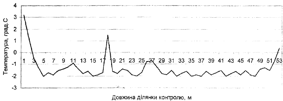
Інформативні параметри у місці ймовірного дефекту
