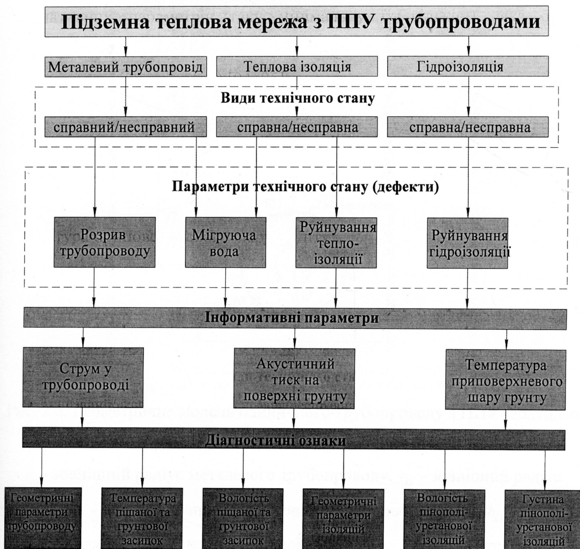
Рис. 2.1. Структурно-наслідкова схема параметрів контролю технічного стану підземних теплових мереж з трубопроводами в ППУ-ізоляції
