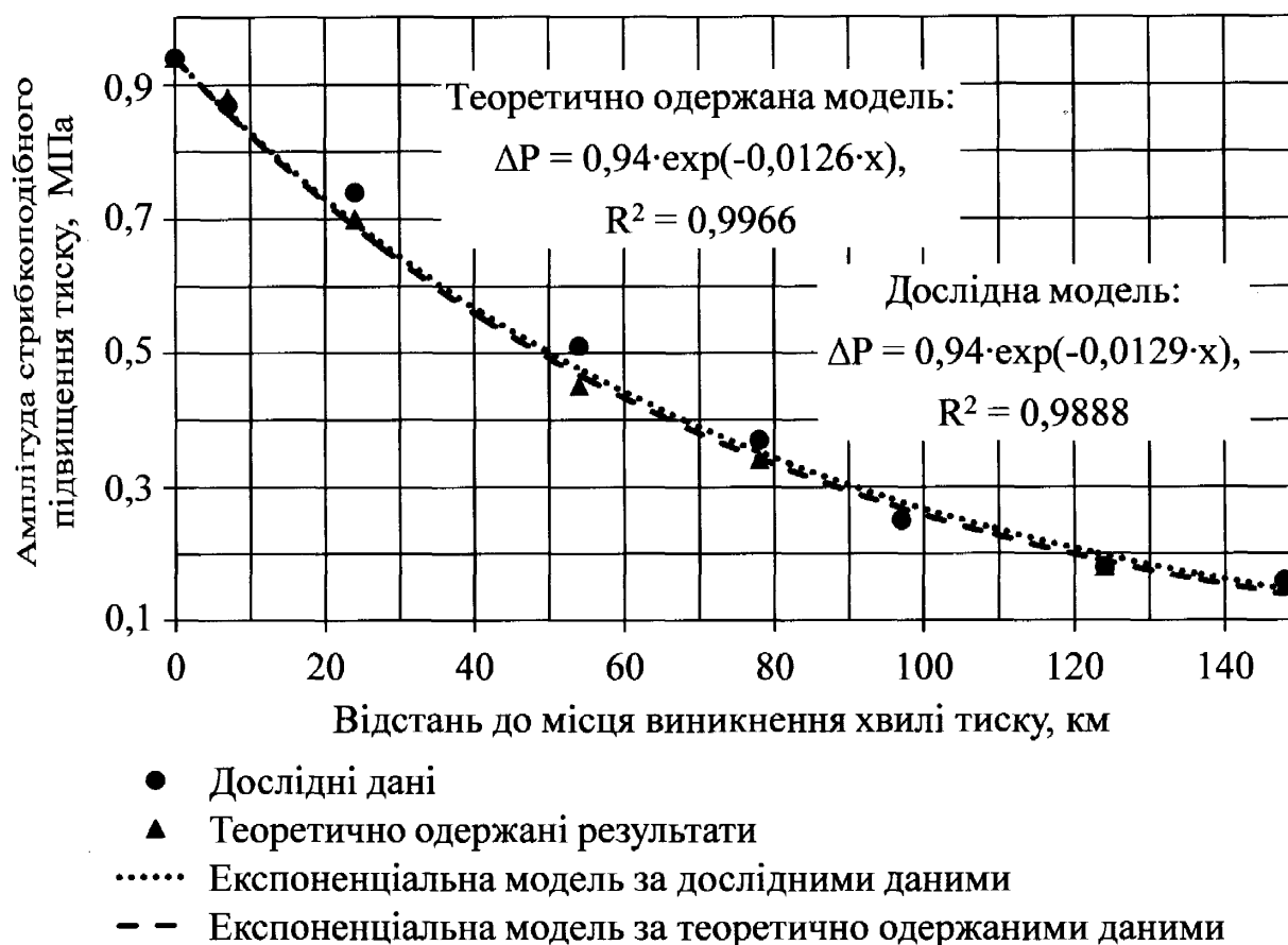
Рисунок 3.8 – Залежність величини стрибкоподібного підвищення тиску нафти від відстані до НПС 4, де зупинили насосний агрегат, за теоретичними розрахунками та результатами експерименту (витрата до зупинки 1689 м 3 /год)
