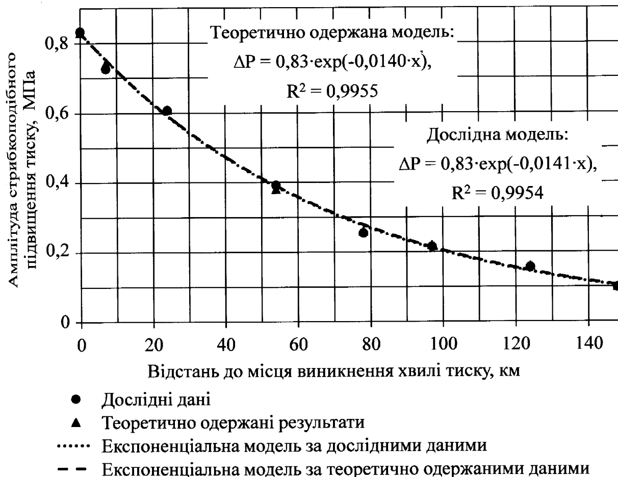
Рисунок 3.9 – Залежність величини стрибкоподібного підвищення тиску нафти від відстані до НПС 4, де зупинили насосний агрегат, за теоретичними розрахунками та результатами експерименту (витрата нафти до зупинки 2096 м 3 /год)
