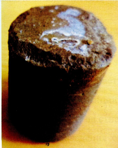
Рисунок 1.7 – Тампонажний зразок затворений на морській воді ( a ) та динаміка зміни міцності зразків цементних каменів в часі ( б ), затворених на технічній та морській воді
