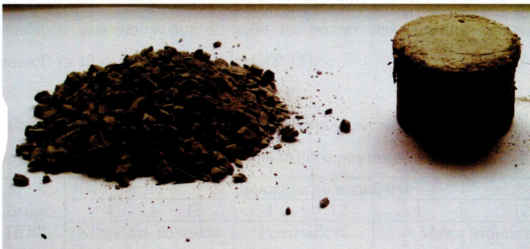
Рисунок 2.10 – Проміжний результат експерименту дроблення тампонажного каменю з ПЦТ-I-50 (зліва) та з додаванням 1% ППФ (з права).
