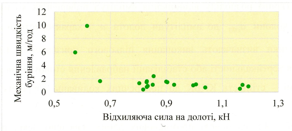
Рисунок 4.1 – Вплив відхиляючої сили на долоті на показники їх відробки
