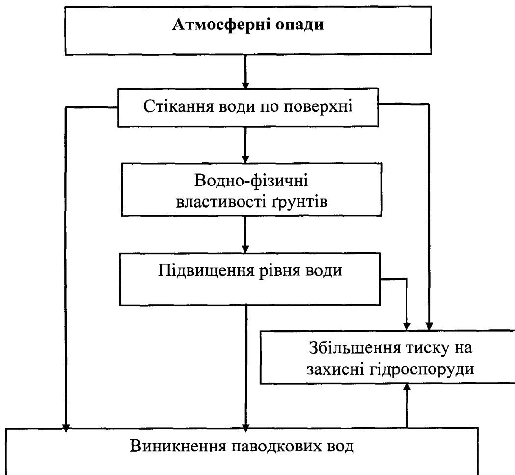
Рис. 2.1 Прогностична схема підняття рівня паводкових вод атмосферними опадами
