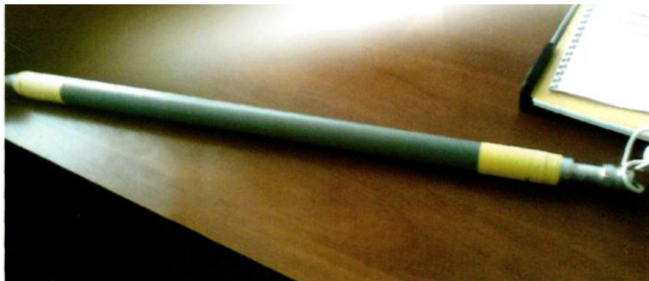
Рисунок 2 - Скважинный иницирующий термоизлучатель
