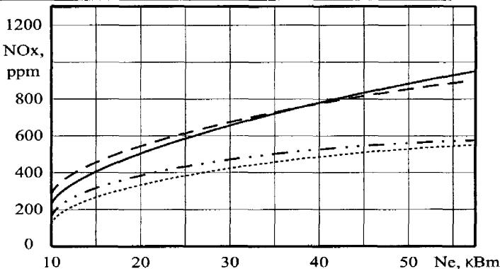
— робота двигуна на дизельному паливі, експериментальна залежність;
