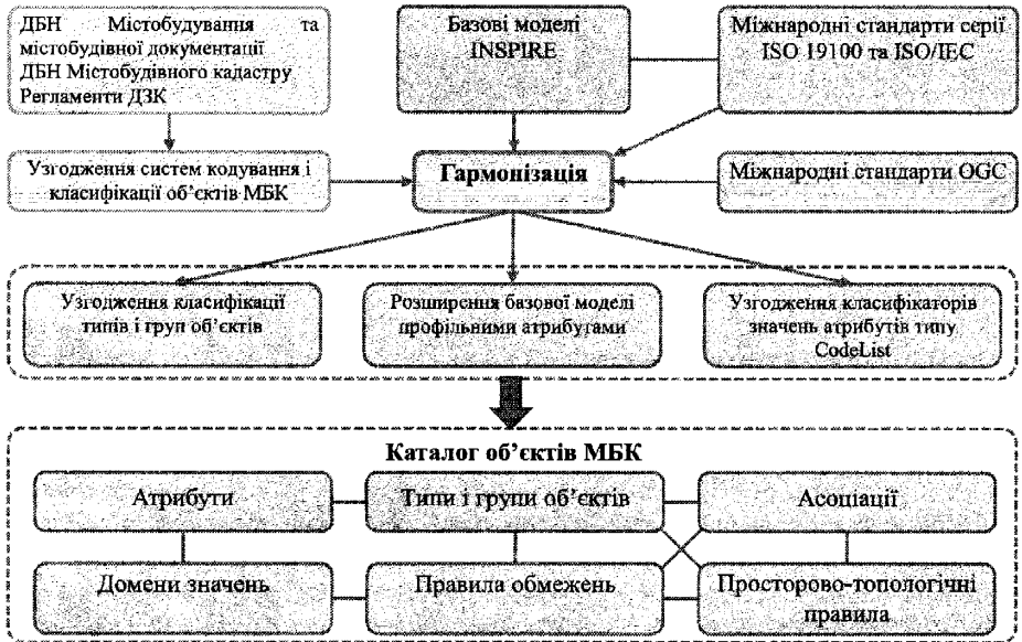
Рис. 3 Функціональна схема уніфікації моделей даних в ГІС МКБ
