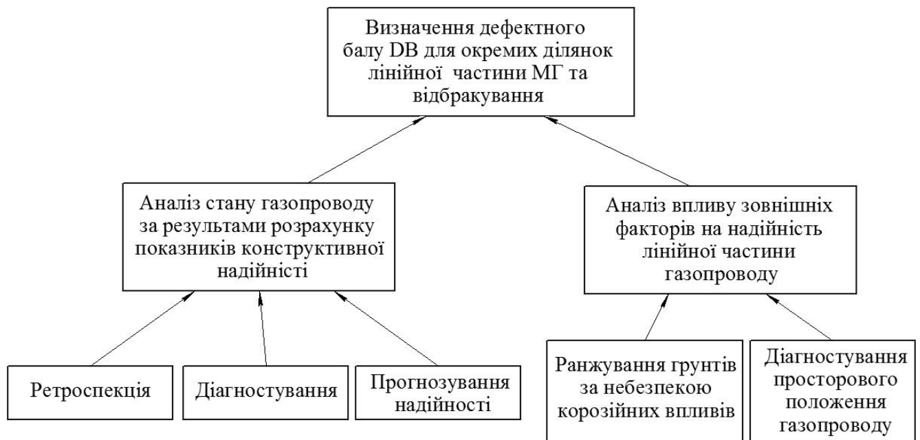
Рисунок 4.1 – Схема відбракування окремих ділянок лінійної частини магістральних газопроводів
