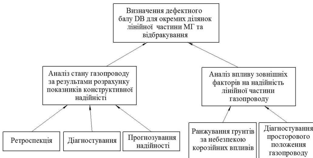
Рисунок 7 – Схема відбракування окремих ділянок лінійної частини магістральних газопроводів
