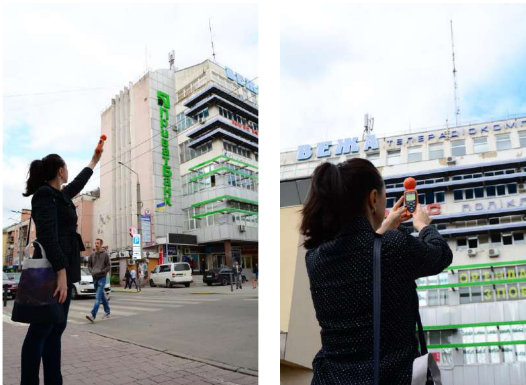
Рисунок 2.11 - Проведення досліджень електромагнітного навантаження в межах урбосистеми м.Івано-Франківська (вул. Галицька, Телерадіокомпанія «Вежа»)
