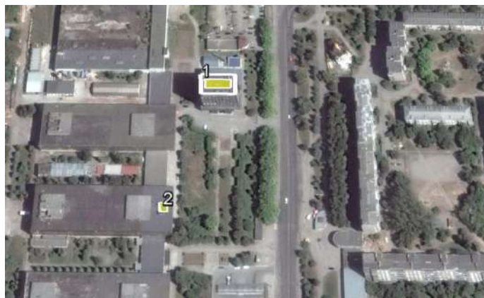
Рисунок 4.6 – Схема поширення ЕМП за показником поверхневої густини потоку енергії, мкВт/см 2 , на території навчального корпусу ПВНЗ «Галицька академія»
