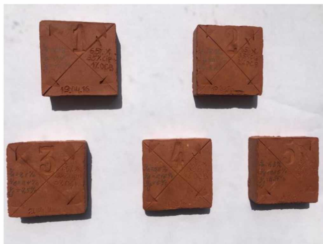
Рис. 8. Зразки цегли повнотілої рядової з модифікуючою добавкою
