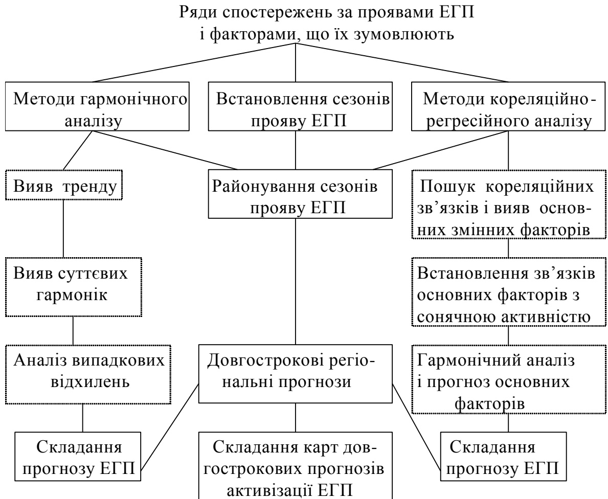
Рис. 1.2. Загальна технологічна схема довгострокових регіональних прогнозів екзогенних геологічних процесів (за А.І. Шеко, В.С. Круподеровим [55]).
