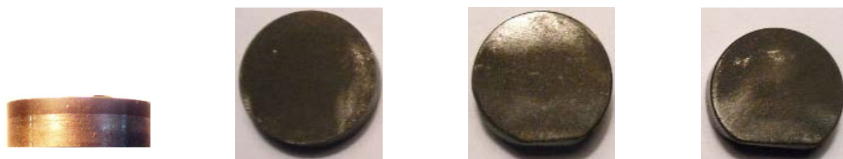
а) б) – нової; в) – з довжиною хорди зношення 5,0 мм; г) – з довжиною хорди зношення 8,0 мм
