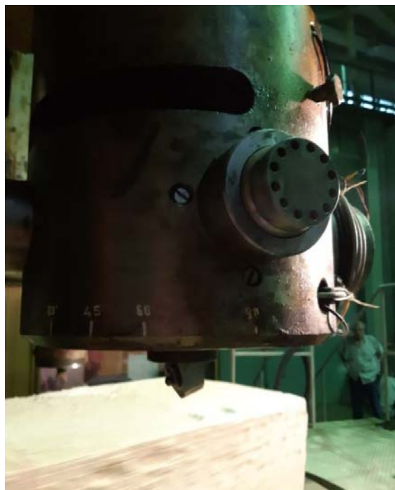
Рисунок 2.4 – Загальний вигляд динамометра із закріпленим різцем
