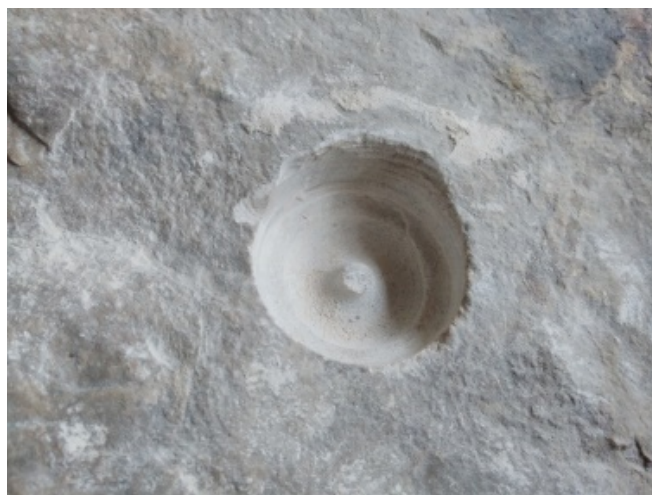
Рисунок 3.6 – Форма поверхні вибою при бурінні
