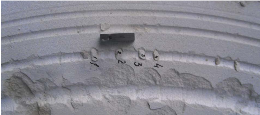
Рисунок 2.9 – Загальний вигляд зони руйнування гірської породи
