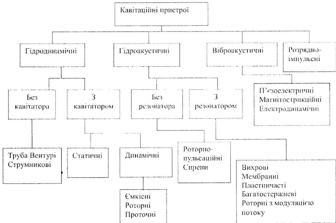
Рис. 6.1. Класифікація кавітаційних пристроїв для оброблення рідких середовищ
