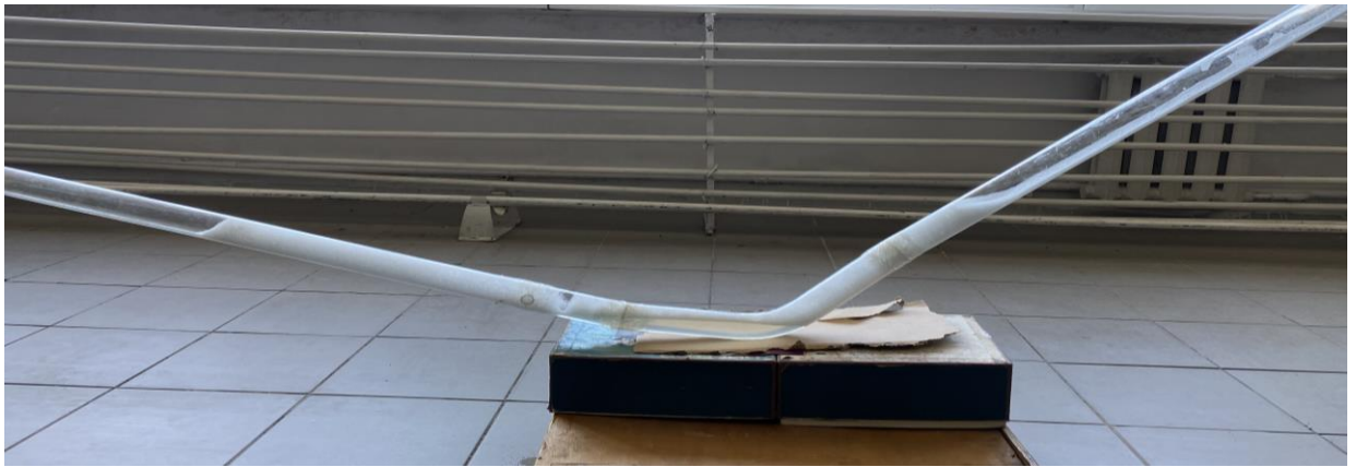
Рисунок 3.15 – Заповнена розчином ПАР понижена ділянка експериментального стенду
