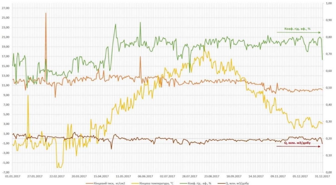
Рисунок 1.9 – Моніторинг впливу кінцевого тиску та температури на коефіцієнт гідравлічної ефективності та продуктивність промислового трубопроводу
