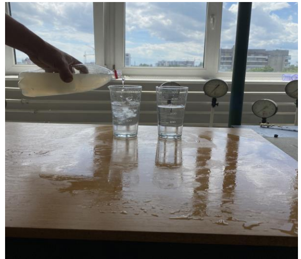
Рисунок 3.14 – Приготування розчину ПАР різної концентрації від 1 % до 5 %
