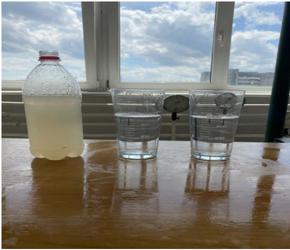
Рисунок 3.14 – Приготування розчину ПАР різної концентрації від 1 % до 5 %
