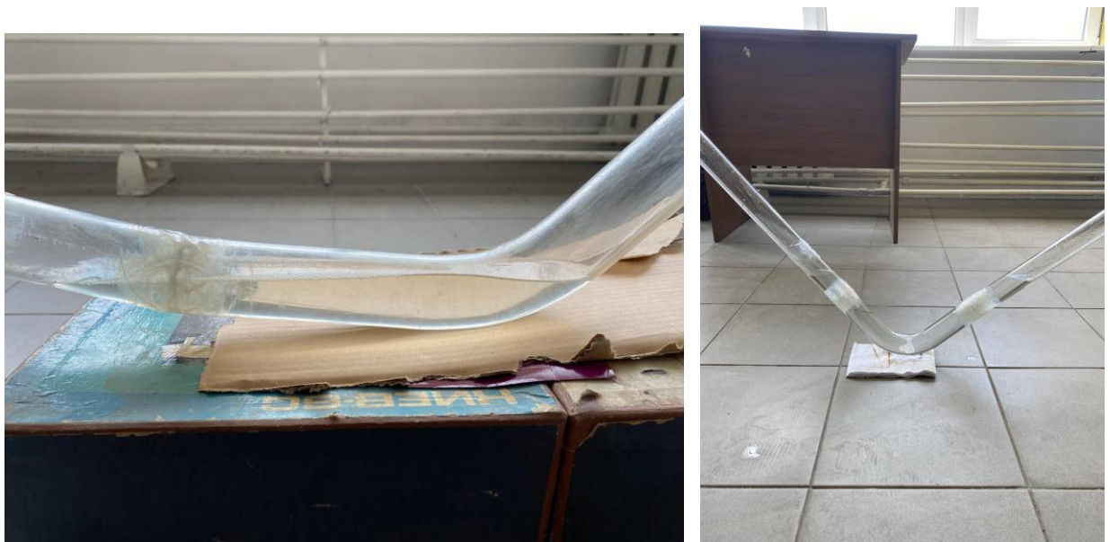
Рисунок 3.16 – Заповнений рідинними забрудненнями скляний відвід експериментального стенду
