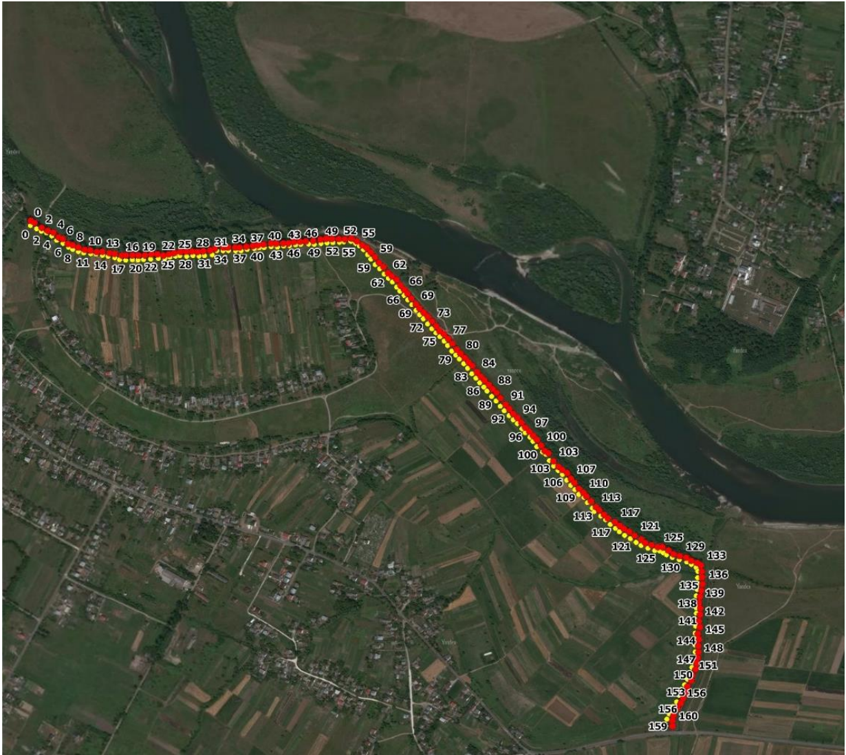
Рисунок 4.5 – Схема розташування точок спостереження методом ПЕМПЗ
