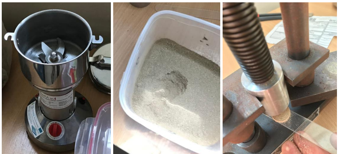
Рисунок 2.17 – Підготовка дослідних зразків для вимірювань калорійності
