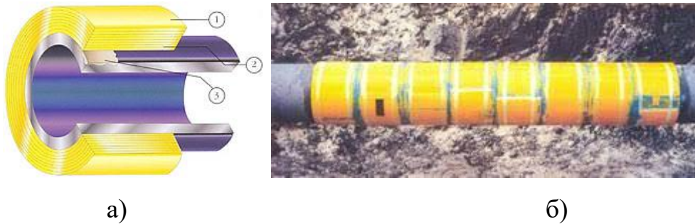
а – конструкція муфти; б - загальний вигляд встановленої муфти; 1 – стрічка з високоміцного композитного матеріалу; 2 – адгезив; 3 -мастика для заповнення зон втрати металу
