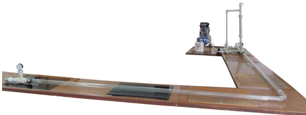
Рисунок 2.1 – Експериментальний стенд для досліджень руху потоків відводом
